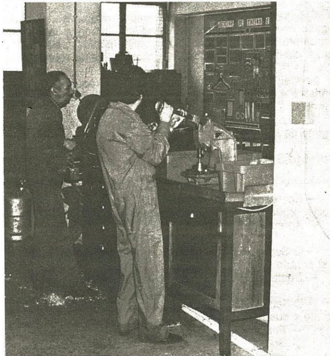
Reparação de vedantes para as torneiras das bilhas de gás
